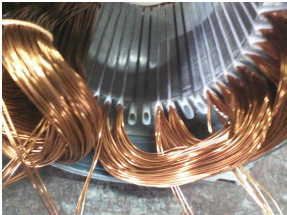
Figura: Detalhe do estator de uma Máquina Síncrona
